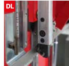
Dispositivo controllo deviazione lama (CNC)
